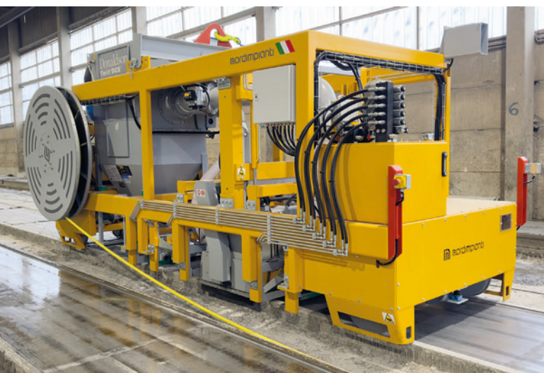
Une machine de nettoyage automatique multifonctions assure la préparation des bancs de préfabrication.
