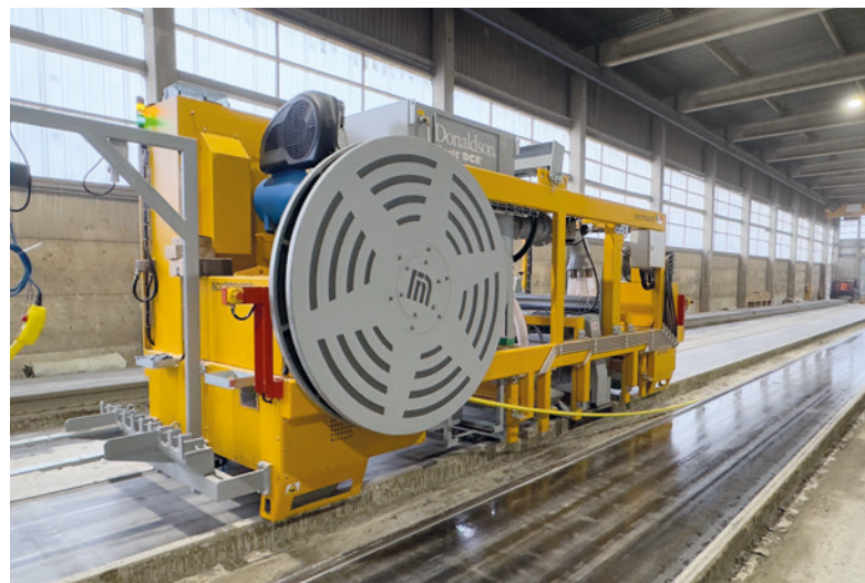
Une machine de nettoyage automatique multifonctions assure la préparation des bancs de préfabrication.
