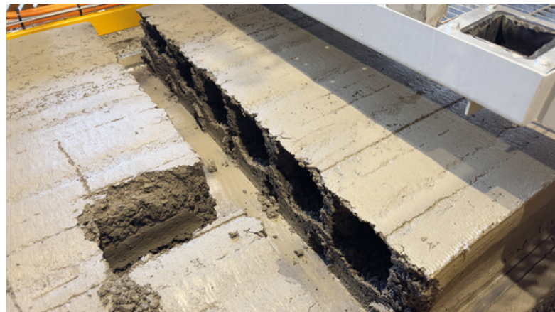
Excellente qualité de coupe du béton frais grâce au nouveau système de coupe
