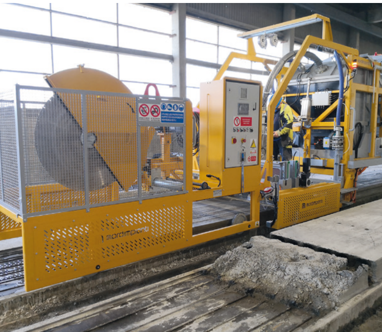
Scie à béton frais automatique combinée à la machine d'aspiration
